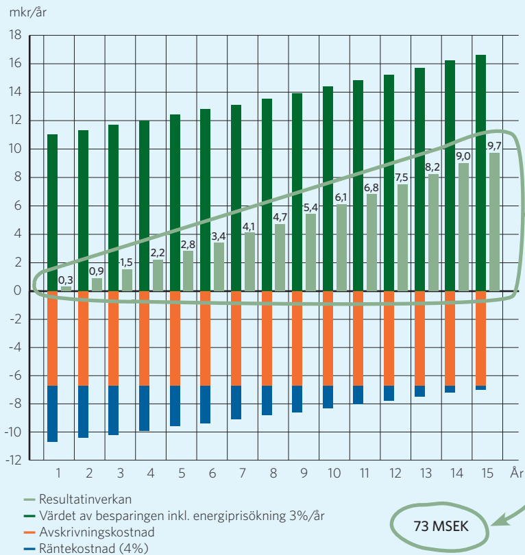
FIGUR 5: Resultatsammanställning för beräkningsexemplet. Resultatinverkan över tiden för en investering om 100 mkr och 11 mkr i besparing per år.
